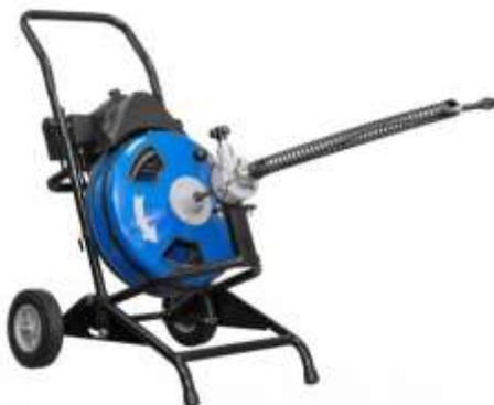
Машина для прочистки канализации Crocodile SP-MD-50 барабанного типа с электрическим приводом предназначена для прочистки канализационных труб  $\varnothing$  32 – 100 мм, длиной до 25 м. Используется в эксплуатационных компаниях, аварийных службах, медицинских, детских учреждениях, сегменте HoReCa, на производстве, в крупных предприятиях и на транспорте в широком диапазоне эксплуатируемых систем канализации и дренажных труб.
